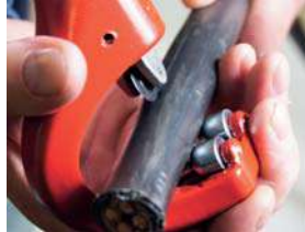
STEP 2: LONGITUDINAL CUT
